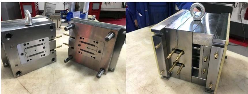
Пресс-форма для изготовления крепежных изделий из высокотермостойких ПКМ методом литья под давлением (установлена сменная вставка для литья шпилек)
