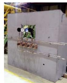
Опытный образец манифольда и имитационный стенд
