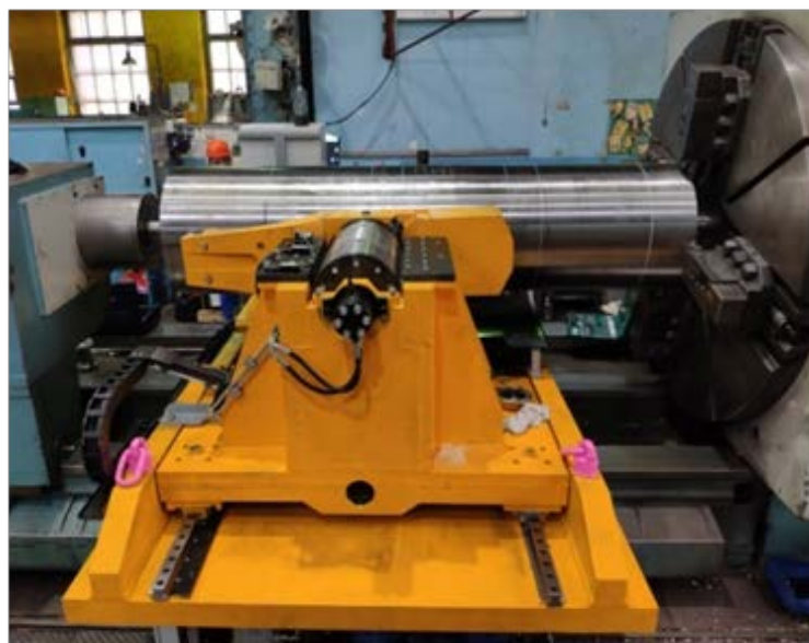
Опытный образец универсального устройства для поверхностного упрочнения гребных валов
