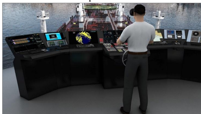
VR-имитатор рабочего места обучаемого ходовых мостиков
