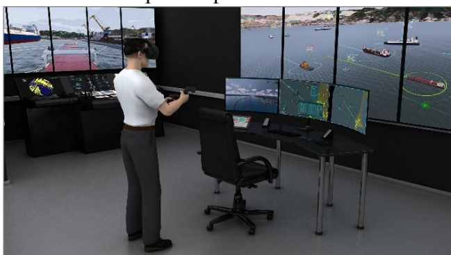
VR-имитатор рабочего места обучаемого СУДС/ЦДУ МАНС
