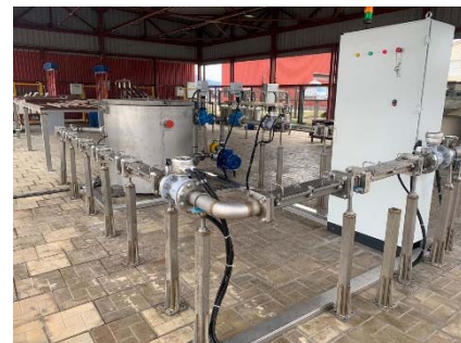
Проведение натуральных испытаний покрытий в движущейся морской воде
