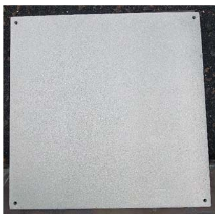
Покрытие с повышенной коррозионной стойкостью для зон повышенной коррозии и переменной смачиваемости
