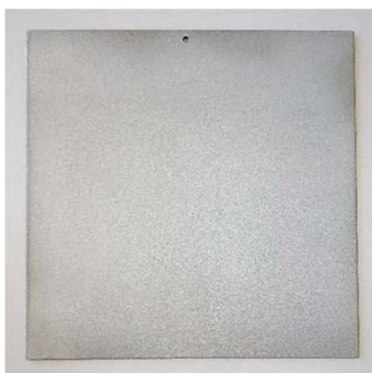
Покрытие с низкой поверхностной энергией против обрастания и против обледенения
