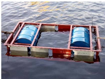
Натурные испытания покрытий в зоне переменного смачивания и зоне полного погружения в акватории реки Волга
