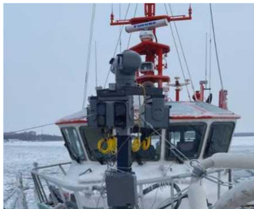
Размещение КОВ-С на мачте судна
